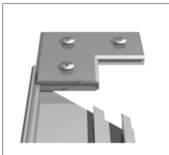
vstavimo kotnike in jih pričvrstimo z vijaki
